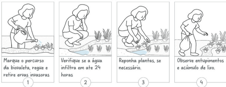
Figura 128: Manutenção de um jardim de chuva
