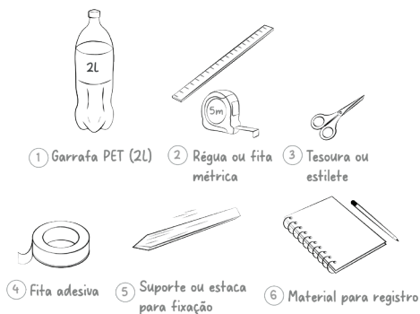
Figura 132: Materiais necessários para construção de pluviPET Fonte: Acervo Laboratório Periférico, 2026
