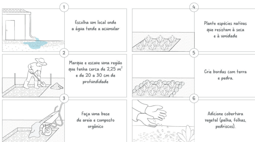
Figura 107: Execução de um jardim de chuva
